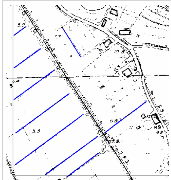
Fig.4 – La rappresentazione delle aste idriche non presenta difficoltà particolari, però, nel caso di elaborazioni automatiche, non è tollerabile la mancanza di continuità del grafo.
