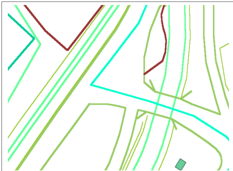
Fig.3 – Uno stralcio di carta numerica, con una grande ricchezza grafica, ma dove si percepisce la mancanza di una strutturazione dell'informazione in oggetti semplici.
