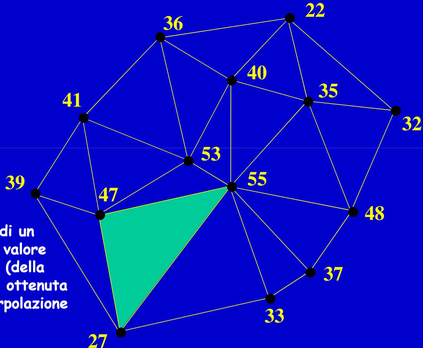
All'interno di un triangolo il valore della quota (della funzione) è ottenuta con un'interpolazione lineare
