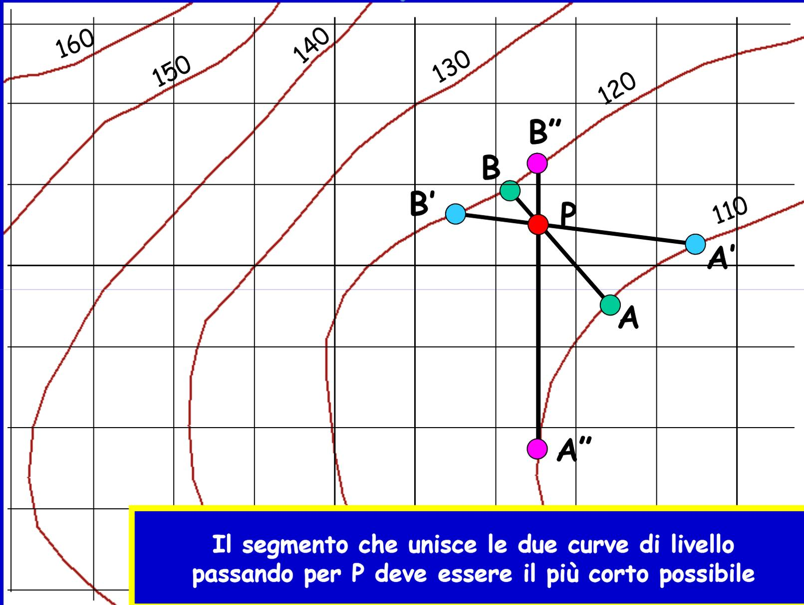
Il segmento che unisce le due curve di livello passando per P deve essere il più corto possibile
